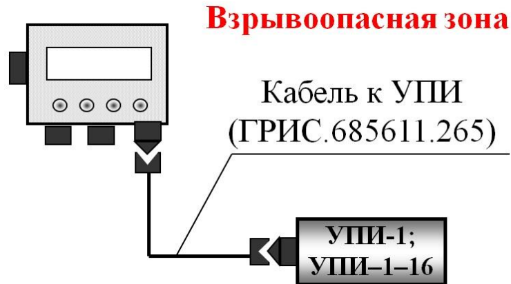
Рисунок 1 – Схема підключення кабелю до УПИ
