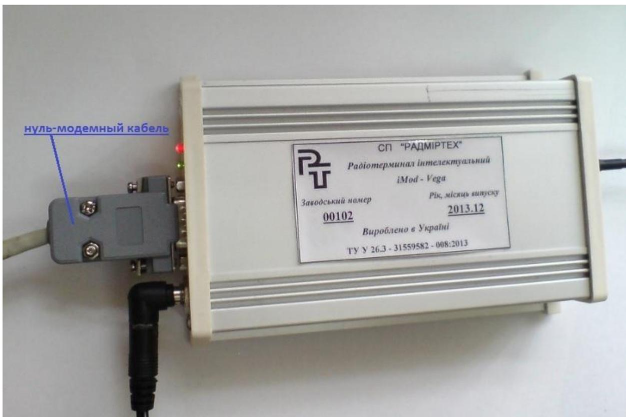
Компьютер и iMod соединяются “нуль – модемным” кабелем (Zero-modem или Z-modem), имеющим на обоих концах розетки, контакты которых соединяются по схеме:
