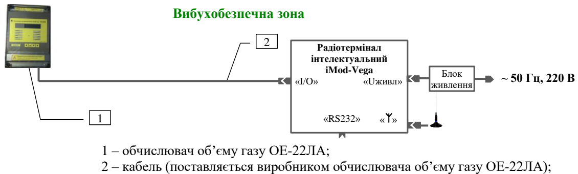
Рисунок 2 – Схема підключення радіотерміналу до коректора об'єму газу ОЕ
