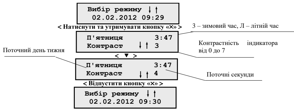
Рисунок 6.2 – Регулювання контрастності індикатора
