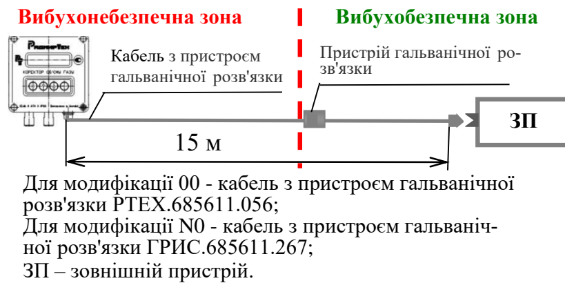
Рисунок 38 – Схема підключення до коректора ВЕГА зовнішніх пристроїв (модем, комп'ютер, тощо) за допомогою кабелю з пристроєм гальванічної розв'язки
