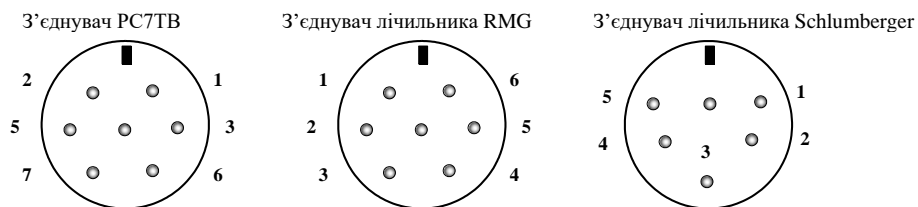
Рисунок 26 – Вид з боку розпайки відповідного з'єднувача (з'єднувача лічильника газу)
