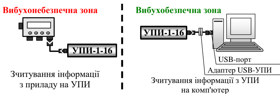
Рисунок 41 – Зчитування інформації з коректорів ВЕГА модифікації 00 за допомогою УПИ-1-16
