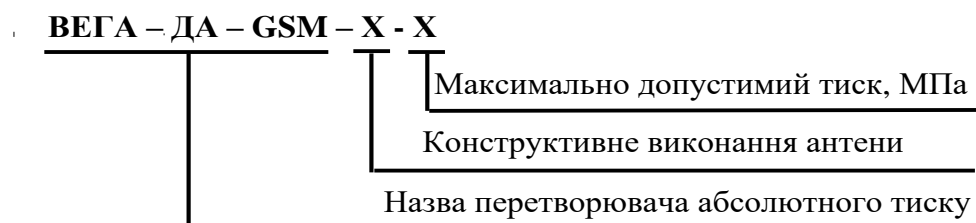
Рисунок 1 - Схема складання умовного позначення перетворювача абсолютного тиску с вбудованим GSM-модемом ВЕГА-ДА-GSM
