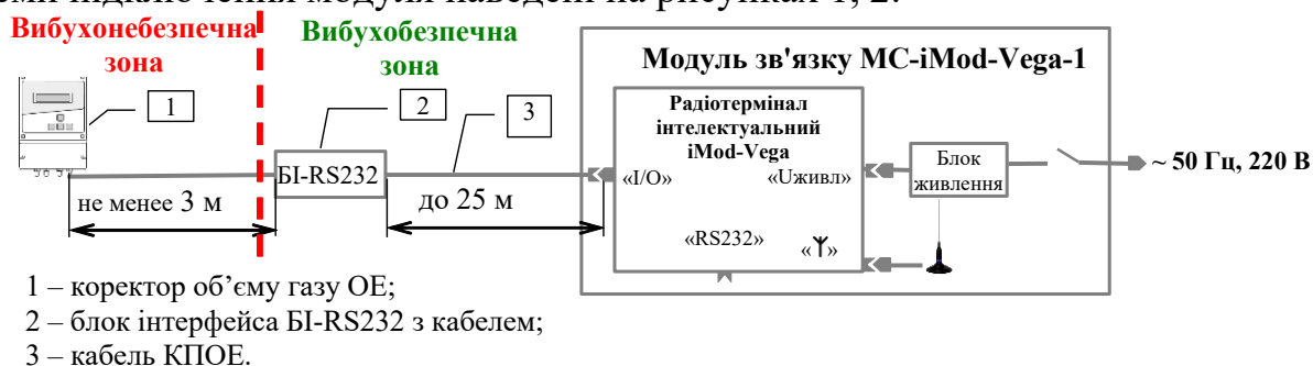
Рисунок 1 – Схема підключення модуля
