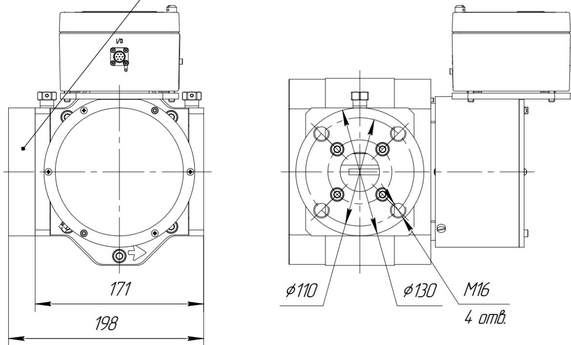
Рисунок В.1 – Схема встановлення фланцю перехідного з комплекту узгоджувального фланцу DN40
