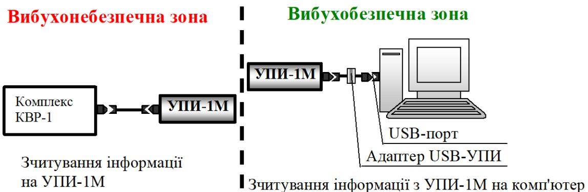
Рисунок 12.11 – Зчитування інформації з Комплекса КВР–1 виконання 00 за допомогою УПИ-1М
