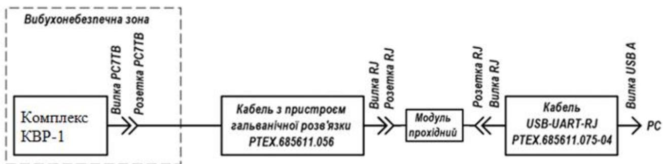
Модуль прохідний з комплекту кабеля USB–UART–RJ РТЕХ.685611.075–04.
