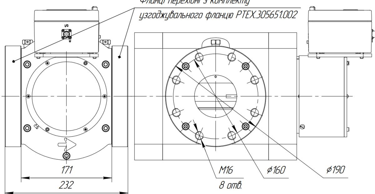
Рисунок В.1 – Схема встановлення фланців перехідних з комплекту узгоджувального фланцу DN80
