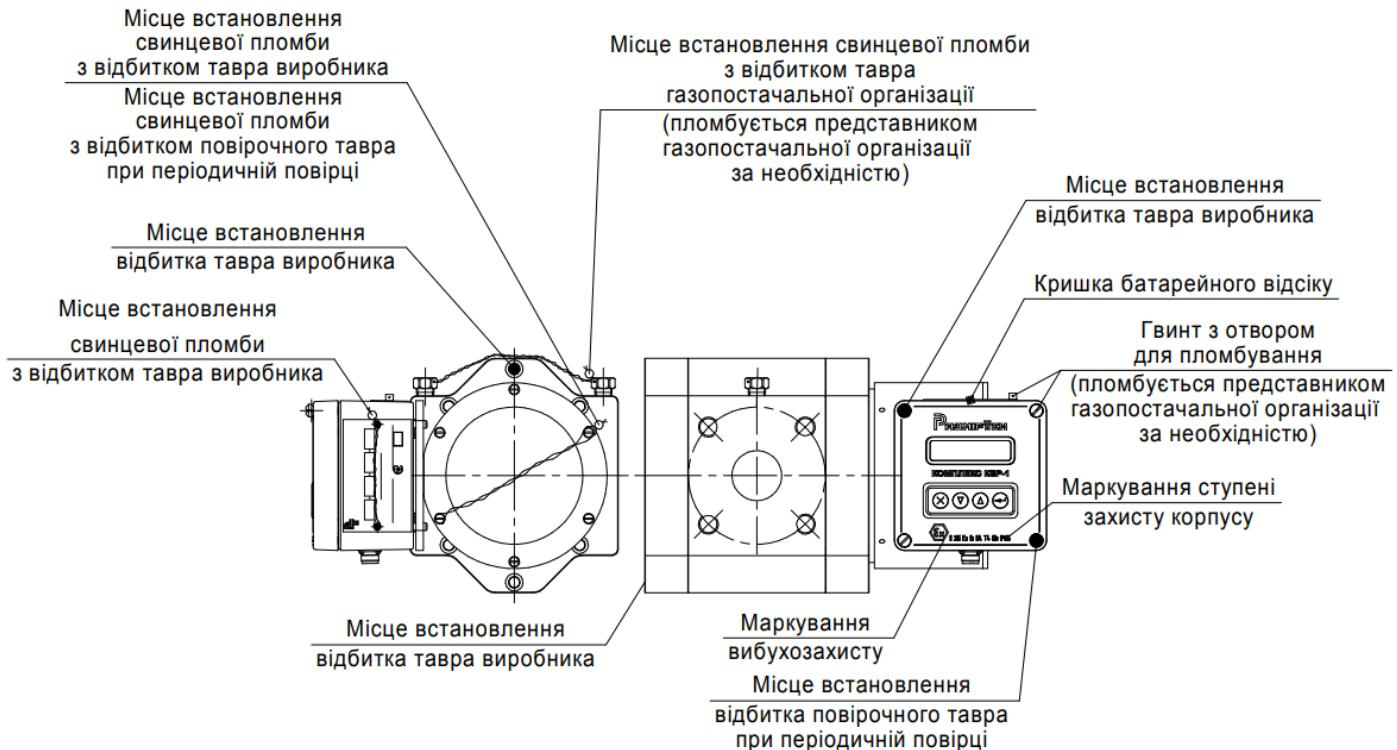
Рисунок Б.1 - Зовнішній вигляд та місця пломбування
