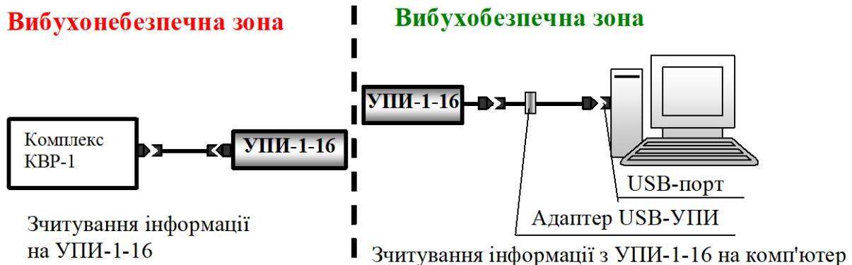
Рисунок 12.12 – Зчитування інформації з Комплекса КВР-1 виконання 00 за допомогою УПИ-1-16
