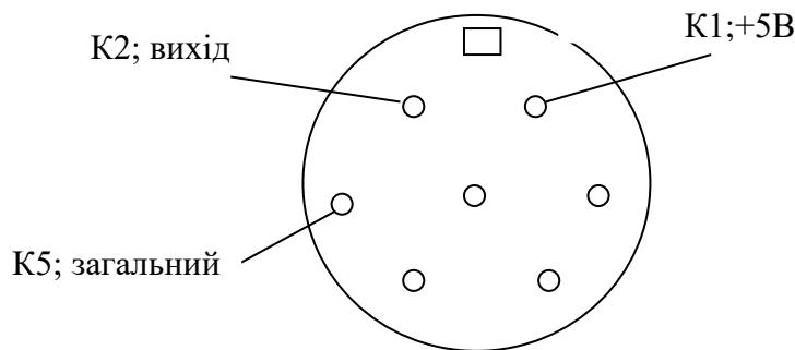
Рисунок 14.2 - Вид вилки РС7 з боку з'єднання
