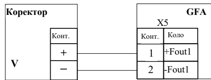
Рисунок 26 – Схема розпайки кабелю коректора до лічильника газу типу «GFA»
