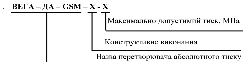
Рисунок 1 - Схема складання умовного позначення перетворювача абсолютного тиску с вбудованим GSM-модемом ВЕГА-ДА-GSM
