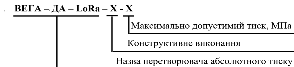
Рисунок 1 - Схема складання умовного позначення перетворювача абсолютного тиску з вбудованим радіомодулем LoRa ВЕГА-ДА-LoRa
