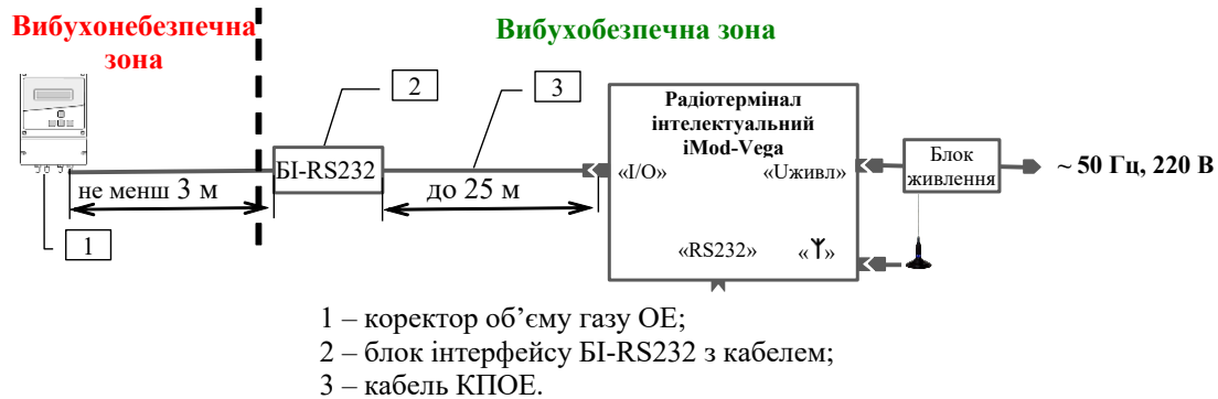
Рисунок 2 – Схема підключення радіотерміналу до коректора об'єму газу ОЕ
