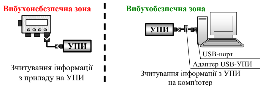
Рисунок 1 – Зчитування інформації з УПІ-1-16 на комп'ютер через USB-порт
