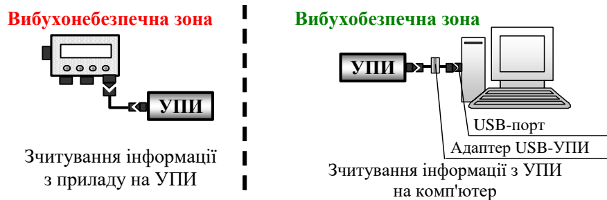
Рисунок 1 – Зчитування інформації з УПИ-1-16 на комп'ютер через USB-порт
