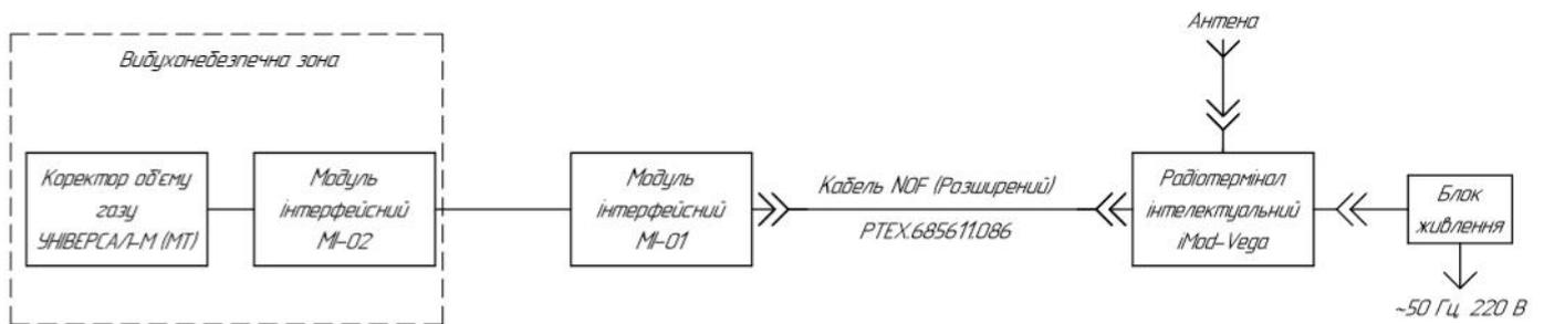
Модуль інтерфейсний МІ-01 та модуль інтерфейсний МІ-02 поставляються підприємством-виробником коректора УНІВЕРСАЛ-М(МТ).
