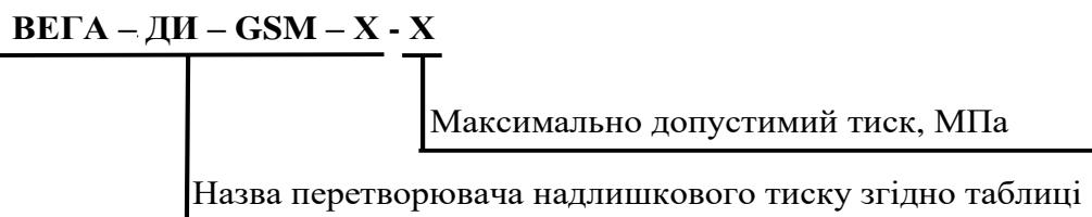
Рисунок 1 - Схема складання умовного позначення перетворювача надлишкового тиску с будованим GSM-модемом ВЕГА-ДИ-GSM
