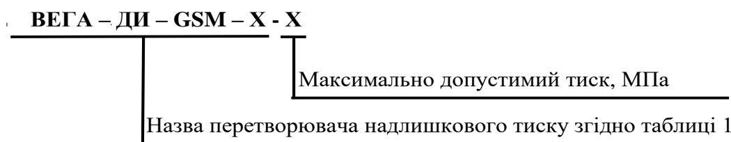
Рисунок 1 - Схема складання умовного позначення перетворювача надлишкового тиску с вбудованим GSM-модемом ВЕГА-ДИ-GSM
