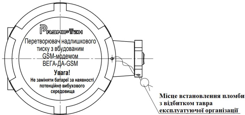
Рисунок 9 – Схема пломбування кришки перетворювача
