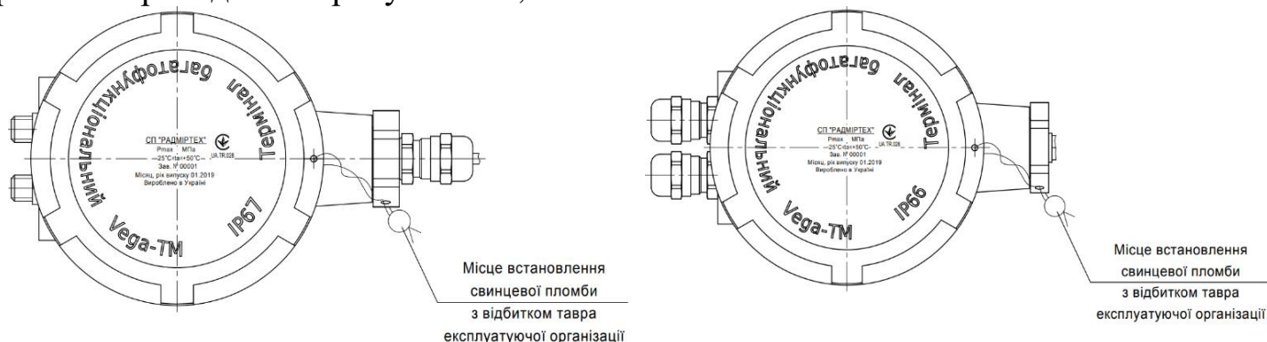
Рисунок 14 – Схема пломбування термінала багатофункціонального Vega-TM-0, термінала багатофункціонального Vega-TM-1 та термінала багатофункціонального Vega-TM-4
