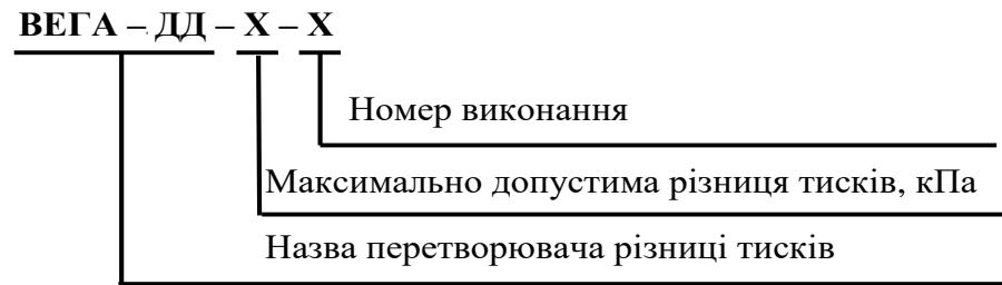
Рисунок 1 - Схема складання умовного позначення перетворювача різниці тисків ВЕГА-ДД
