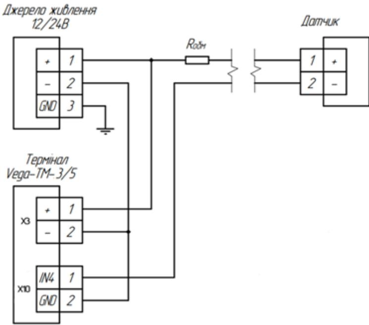
Рисунок 15 – Схема підключення до термінала Vega-TM-3, термінала Vega-TM-5 датчика з зовнішнім струмовим виходом
